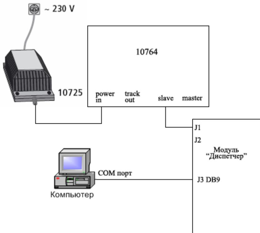
**Схема подключения в системе Lenz:**
