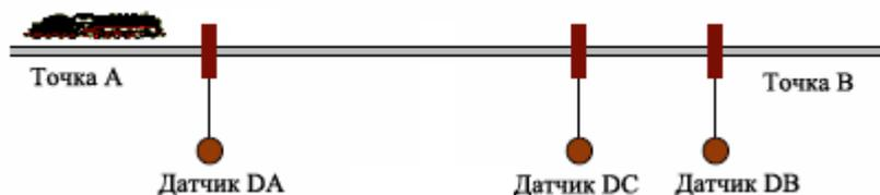
**Программа «Челнок» от точки А до Б с точной остановкой на датчике DB с 3-мя датчиками**
