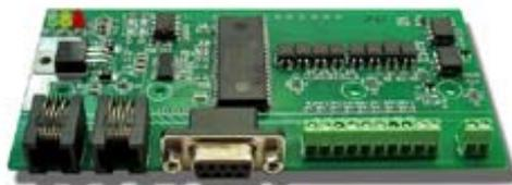
Модуль «Диспетчер» предназначен для организации автоматического управления макетом, построенным на базе DCC станций с ExpressNet.
