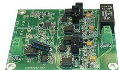
Модуль разворотной петли Super Reverser
