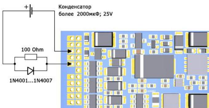
Если требуется подключить конденсатор емкостью более 2000мкФ, то необходимо добавить внешний ограничитель тока заряда, при этом подключать схему нужно к площадке «20V» (или синему проводу) и площадке «GND»
