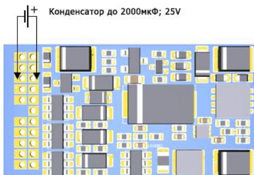
Декодер SoundGT2.1 имеет встроенный ограничитель тока заряда конденсатора, поэтому конденсатор емкостью до 2000мкФ можно подключать напрямую к контактам «GND» и «Конденсатор +»
