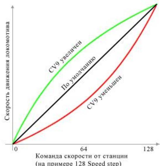
Обычно в декодерах CVmid - это CV6, но в декодерах modelldepo эта CV традиционно занята под младшую цифру версии, поэтому CVmid стала CV9.
