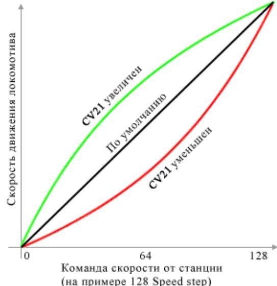
Обычно в декодерах CVmid - это CV6, но в декодерах modelldepo эта CV традиционно занята под младшую цифру версии, поэтому CVmid стала CV21.
