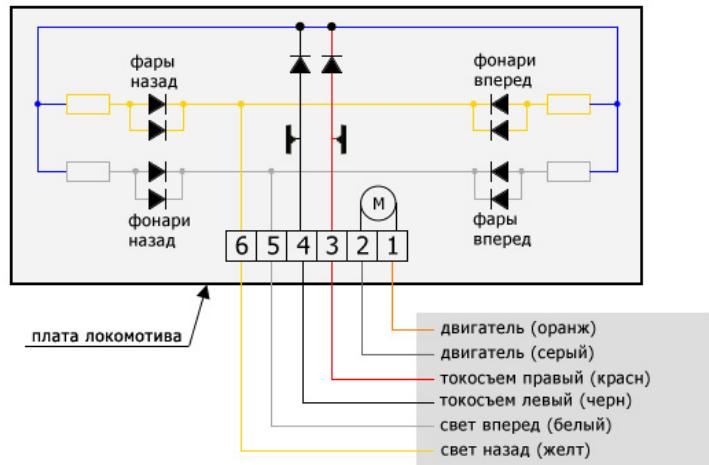
Если в локомотиве нет разъема соедините провода пайкой в соответствии со схемой:
