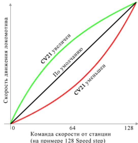
Обычно в декодерах CVmid - это CV6, но в декодерах modelDepo эта CV традиционно занята под младшую цифру версии, поэтому CVmid стала CV21.
